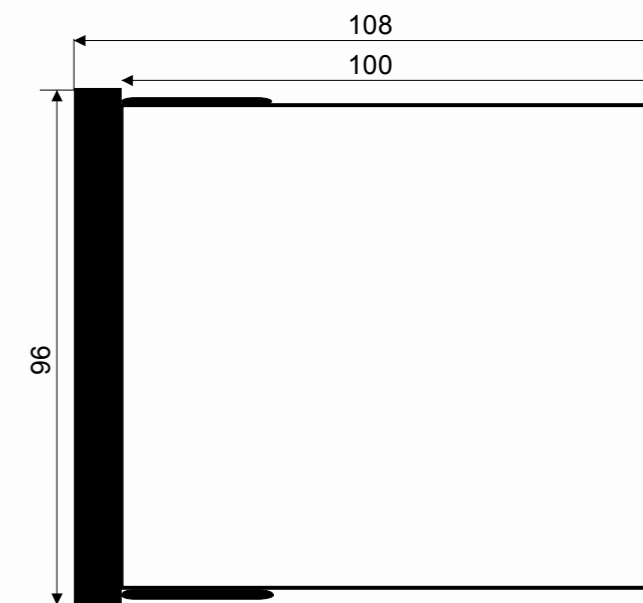
Rys. 4. Widok i wymiary z boku urządzenia DEC-1
