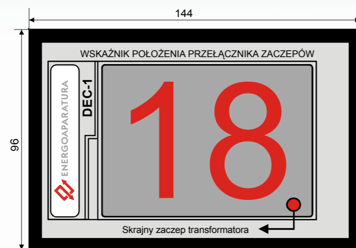
Rys. 1. Wymiary zewnętrzne wskaźnika położenia przełącznika zacze- pów
