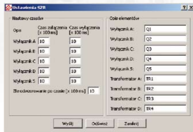
Rys. 14. Okno z ustawieniami SZR
